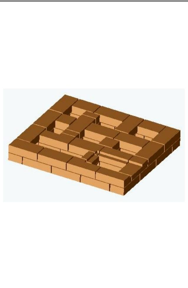
24 ряд. Делаются вырезы в кирпичах для установки каминной задвижки. Перекрываетяется дверца прочистки, установленная в 22 ряду. Два кирпича в каналах печи срезаются наискосок сверху. Количество кирпичей – 22 (красный).
