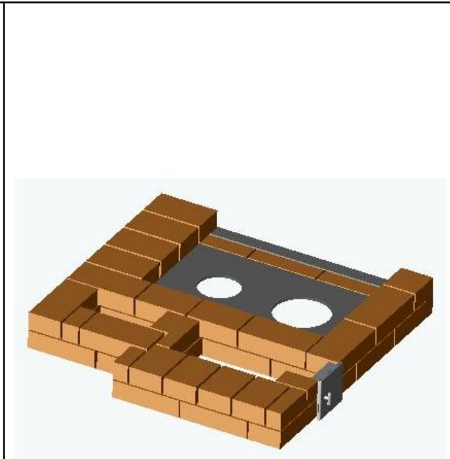
11 ряд. Начинаем формировать варочную камеру. Кирпичи, установленные с правой стороны камеры имеют размер 210 мм. Они перекрывают получившийся промежуток между варочной плитой и правой стенкой печи. Кирпичи над топливным отверстием камина выпускаются внутрь топливника на 40 мм и срезаются снизу под углом. Количество кирпичей – 18 и ½ (красный).
