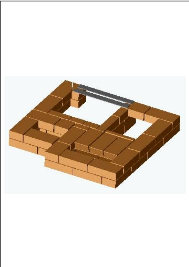
9 ряд. Для перекрытия дверцы духового шкафа используются две стальные полоски 50x5x480 мм.
