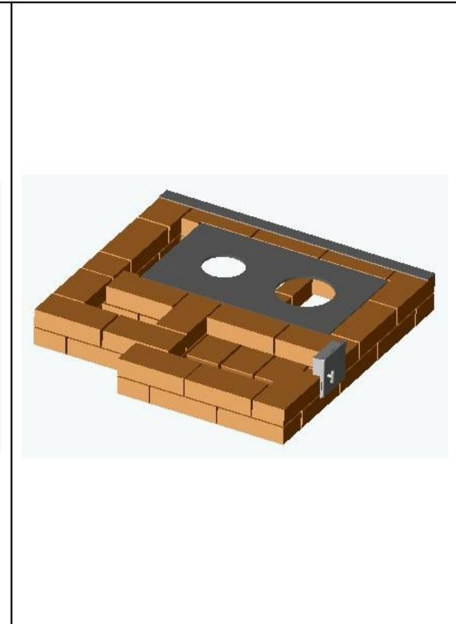
10 ряд. Устанавливается чугунная двухконфорочная плита 410x710 мм, дверка прочистки 140x140 мм и уголок на входе в варочную камеру 50x50x5x1020 мм.
