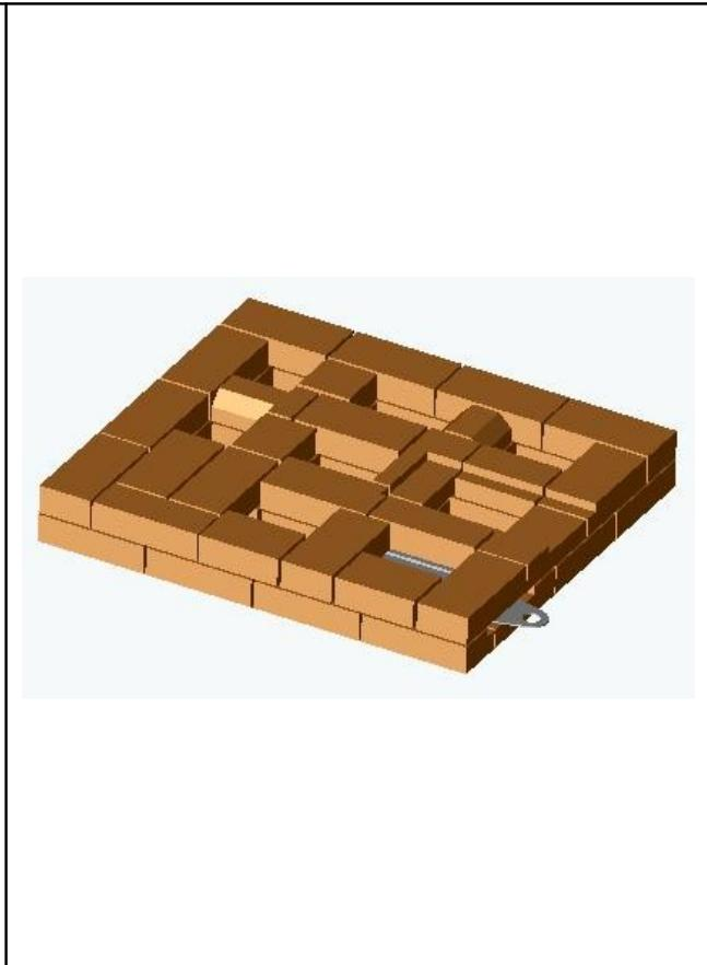
25 ряд. В основном вертикальном канале делается еще одна полка (излом канала). Вырезаются кирпичи для установки задвижки печи. У двух кирпичей, разделяющих каналы газоходов, срезаются под углом верхние грани. Количество кирпичей – 24 (красный).
